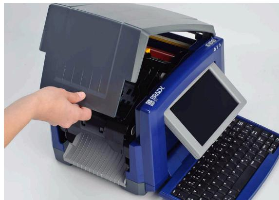
2. Освободите фиксатор на крышке риббона [2] и откиньте крышку.
